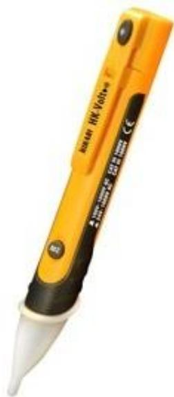
*O Detector de Tensão Modelo HK-VOLT se destaca por detectar tensão AC. O instrumento é destinado a verificar a presença de tensão AC, sinalizando o usuário com um Led e um Bip. Como característica adicional possui uma lanterna embutida de alto brilho.*
