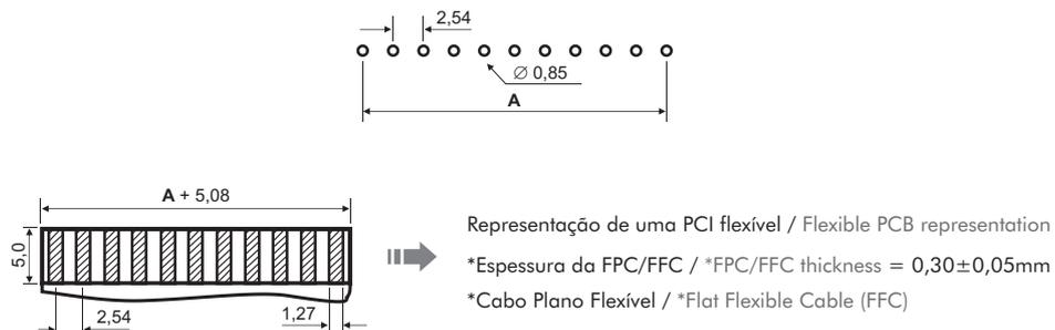
Tolerância / Tolerance : ± 0,20 mm
