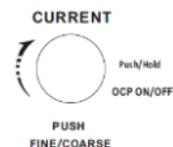
Pressione o knob de Corrente e o display começará a piscar. Faça o ajuste de corrente girando o knob. Para ajuste fino basta pressionar novamente o knob e mudar de dígito do display e assim sucessivamente com os outros dígitos. Para determinar o limite máximo de corrente ajuste a corrente desejada, pressione e segure o knob por 3 segundos, a
