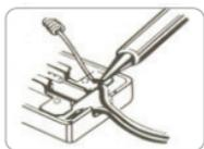
Esperre a solda esfriar antes de movimentar as partes soldadas.
