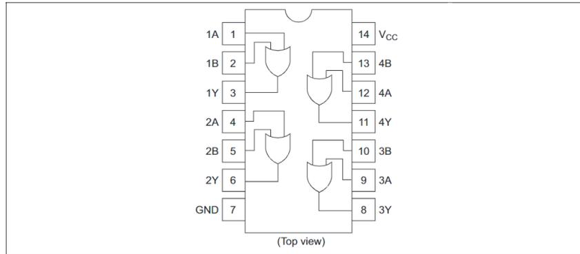
A Operação OR (OU) atua algebricamente como uma soma, tendo como resultante a soma de nível lógico imposto nas entradas. Assim  $Y=A+B$  (leia-se que a saída Y é igual a A OU B), e quando qualquer uma das entradas A ou B, estiverem em nível lógico Alto (High = 1), a saída Y será também uma saída com nível lógico Alto. A saída Y só será baixa (Low = 0), quando as duas entradas A e B estiverem com nível lógico baixo (Low = 0).
